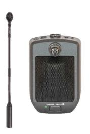
Die universelle Mikrofonbasis wird in Verbindung mit dem Taschensender TS 1 oder TS 2 eingesetzt, indem dieser in das Gehäuseinnere eingelegt wird. Das Grenzflächen-Mikrofon verfügt über eine Halbnierencharakteristik und nimmt Sprachsignale aus einem Radius von bis zu 1,5 m auf. Es kann ohne oder mit Schwanenhalsmikrofonen unterschiedlicher Längen eingesetzt werden und ist in der Farbe Schwarz erhältlich.
